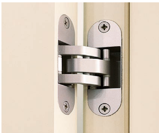
Скрытые петли (пр-во Италия) в цвете матовый хром установлены в заводских условиях, на дверях высотой 2000 мм — 2 петли, 2100-2200 мм — 3 петли, высотой 2300 мм — 4 петли.
